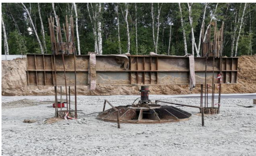
Рисунок 13 – Общий вид штампового испытания армированного основания (площадь штампа 38 000 см 2 )
